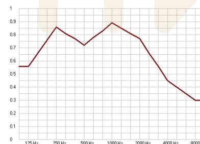
Absorption acoustique avec plenum de 200mm et laine minérale de 40mm
