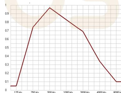
Absorption acoustique avec plenum de 40mm
