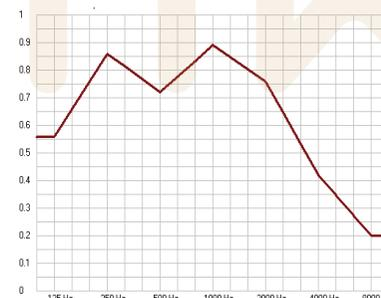
Absorption acoustique avec plenum de 200mm
